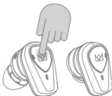
イヤホン本体の電源を切るには、マルチファンクションタッチセンサーを5秒間長押しします。"ポンポン"という音が聞こえたら指を離します。その後"Power off"という音声案内が流れ電源が切れます。電源が切れる際にオレンジのインジケーターが1秒間点灯します。
