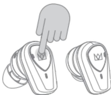
イヤホン本体の電源が切れているときは、左右のイヤホンのマルチファンクションタッチセンサーを軽く押すと、"Power on"という音声案内が流れて電源が入ります。
